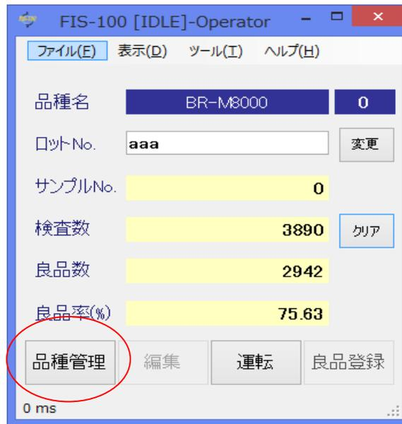
2. 品種管理画面が開きますので、検査したい品種を選択して、「開く」ボタンをクリックします。
