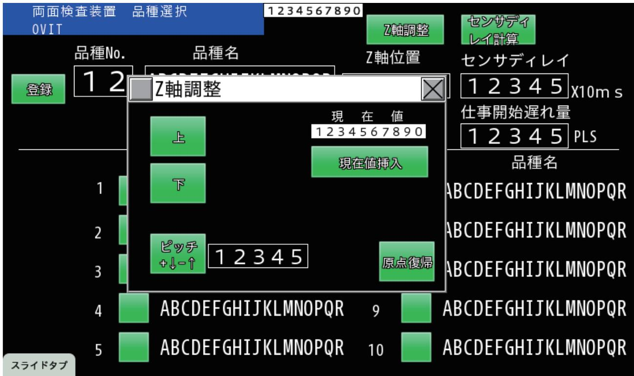
画像ソフト FIS にてカメラをライブしながら、この Z 軸を動作することで、ピントが合う位置に移動させることができます。
